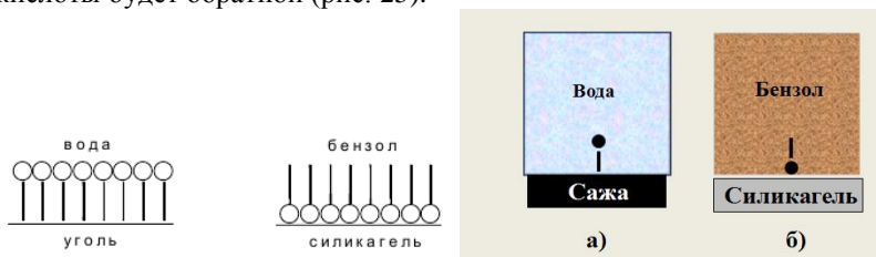
Рис. 25. Ориентация молекул ПАВ на поверхности адсорбента
